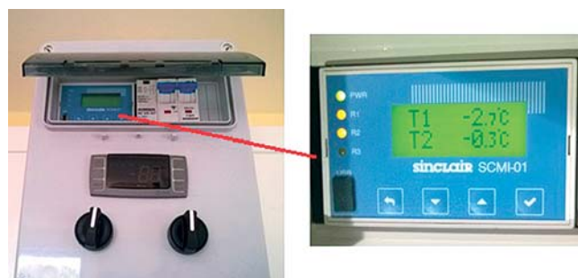
4. ábra. A PID szabályozó kialakítása
