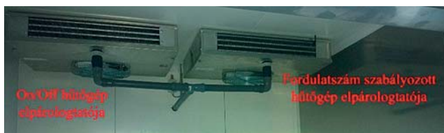
2. ábra. Az elpárologtatók kialakítása a kísérleti tesztkamrában
