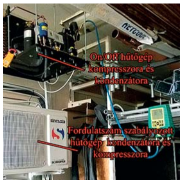
5. ábra. A hűtő-aggregátok kialakítása
