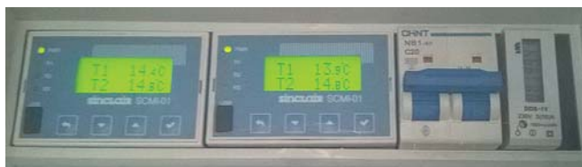
7. ábra. A kamrán elhelyezett PID szabályozó és a mérőműszerek kijelzői
