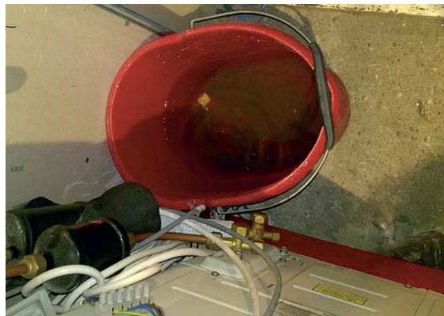
14. ábra. A szárítási művelet során a kolbászokból kinyert nedvesség mennyisége egy nap után
